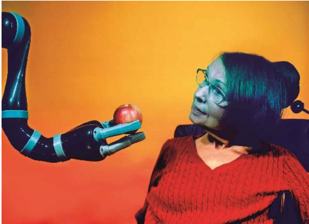
患者S3（凯茜·哈钦森）在中风后四肢瘫痪。在美国布朗大学约翰·多诺休的实验室里，她正用脑控制一个机械臂来吃苹果。这是十几年来她第一次能够靠自己进食。她在之后表示：“控制机械臂感觉挺自然的。”
