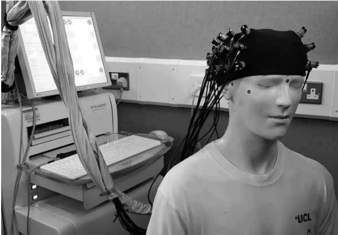
图33 功能性近红外光谱通过把红外激光透过头皮射入大脑来监测大脑活动。活跃的神经元会消耗附近血液中的氧气，因此血液的颜色会从鲜红色变为暗红色。功能性近红外光谱帽中的传感器能检测到大脑反射的红外光，从而监视神经活动。它是脑电图和fMRI 等功能性大脑成像（速度较慢）的一种补充
